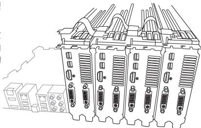
5. 将四条电源线分别从电源连接至四张显卡的电源插座上。
