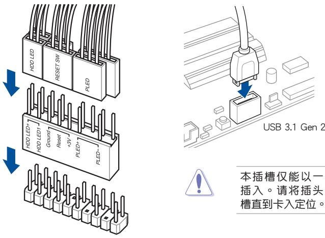
本插槽仅能以一个方向插入。请将插头压入插槽直到卡入定位。
