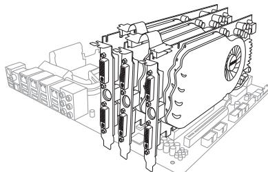
5. 将三条电源线分别从电源连接至三张显卡的电源插座上。
