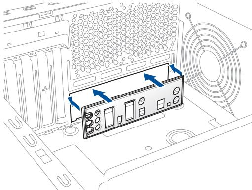
2. 将主板放入机箱，并确认后侧 I/O 连接端口对齐机箱的后侧 I/O 面板。
